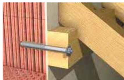
Фрагмент: Деревянные конструкции при сквозном монтаже
