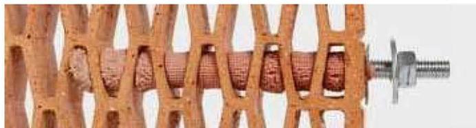
При введении анкерного элемента в сетчатую гильзу вытесняемый химический состав проходит через ячейки гильзы, оптимально заполняя пустоты и обеспечивая молекулярную адгезию с внутренними перегородками. После отверждения состава образуется надежное монолитное соединение равнопрочное материалу основания.
